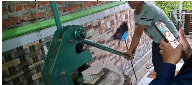
Gambar 1. Pembuatan Pola Menggunakan Mesin Plong dan Pisau
